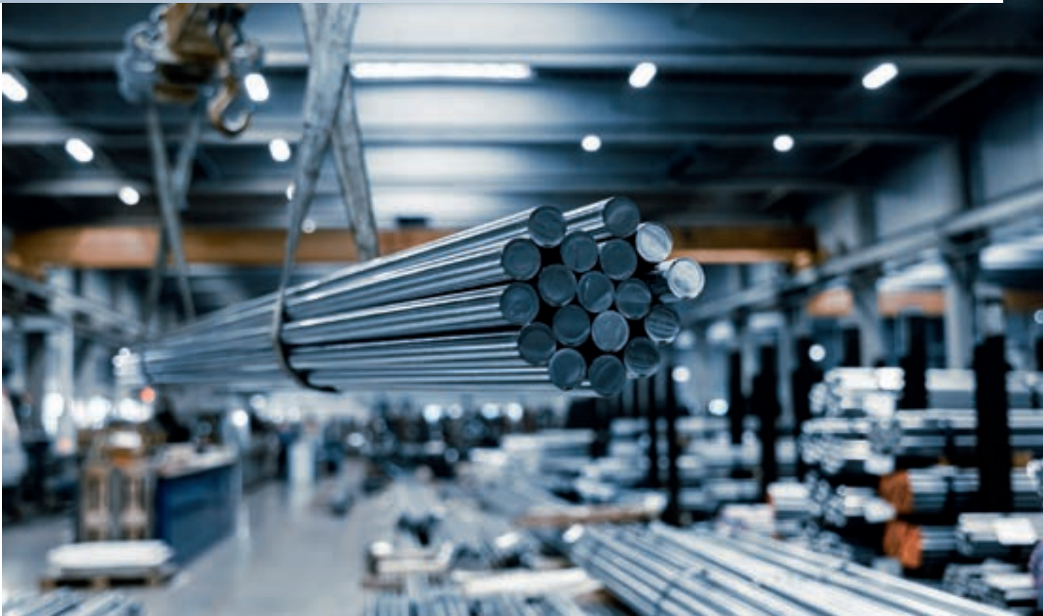
Oberflächenveredelung vom Feinsten: Auf den Blankstahlanlagen von GABO STAHL werden die Stäbe auf engste h-Toleranzen geschält.
